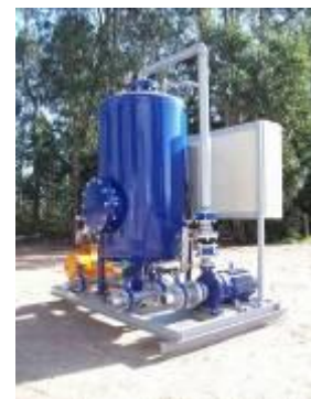
Kit de Saturación montado en estructura metálica.
