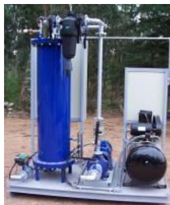
Kit de Saturación montado en estructura metálica.
